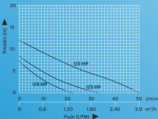
Con temperaturas inferiores a 5 °C vaciar la Bomba Rotoplas para evitar desperfectos o daños causados por el hielo. Valores basados en pruebas de laboratorio con agua limpia, libre de sólidos y gases, al nivel del mar.
